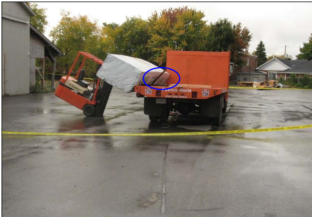
Photo 1 : Zone d'écrasement entre la charge et le camion Source : CSST
